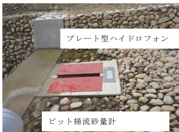
写真-2 プレート型ハイドロフォンとピット掃流砂量計
