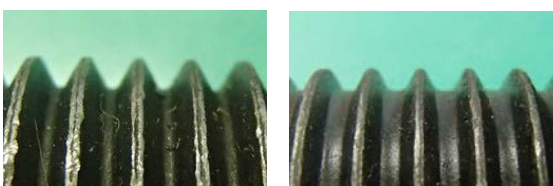
高力ボルトのねじ形状の例 超高力ボルトのねじ形状の例
