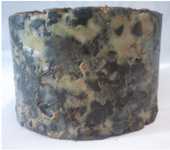
写真-1 樹脂コーティング状況
