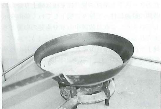
写真-1 ガスコンロ法による試験状況
