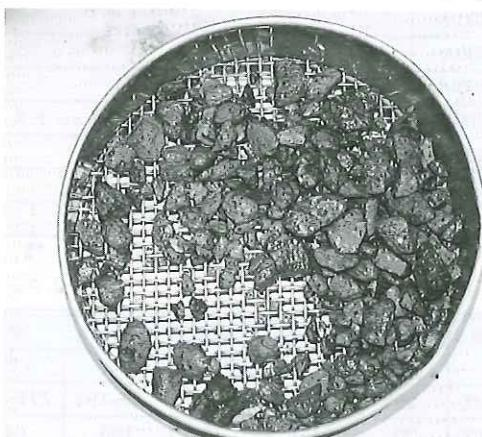
写真-2 骨材にベーストが付着した状態
