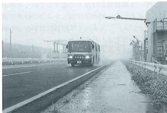
写真-1 雨天時の試験状況とすべり摩擦測定車
