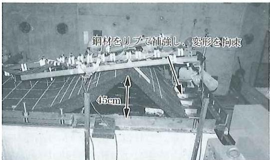
写真-2 舗装部の損傷(舗装部が折れ曲がった状況)
