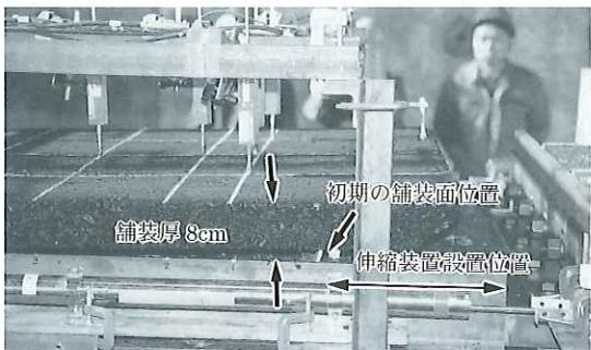
写真-1 舗装部の損傷(伸縮装置に乗上げた状況)
