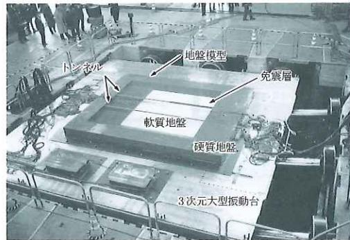
写真-1 地盤条件急変部を対象にした模型振動台実験
