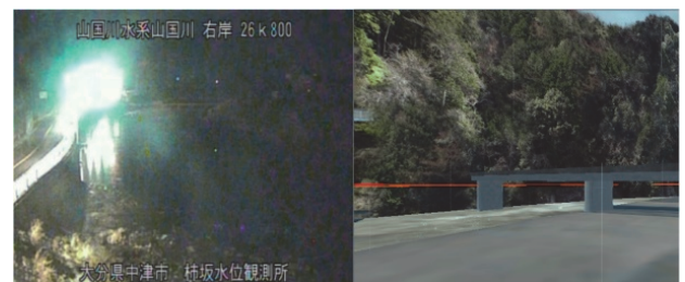
図-8 夜間同時刻での比較 1) (山国川26.8KP付近) (左：CCTVカメラ画像（橋梁より下流位置）、 右：VR表示画像（橋梁より上流位置）)
