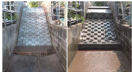
(a) 越流水深20cmで通水した後の裏法部の状況 (b) 滑動し折れ曲がった連節ブロック
