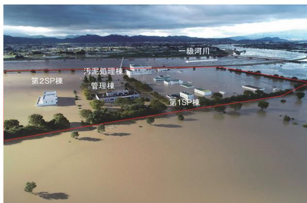
図-2 外水氾濫により浸水した下水処理場
