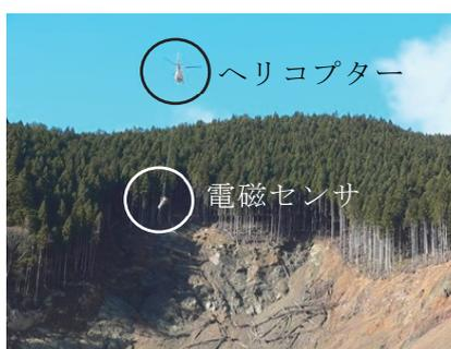
写真-2 奈良県天川村の深層崩壊発生斜面（冷水（ひやみず）地区）でのヘリコプター空中電磁探査の様子（2012年12月）
