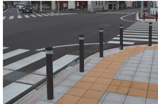
写真-1 耐衝撃性のあるH型ボラード
