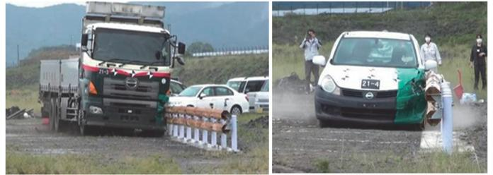
写真-7 木製防護柵の大型車と小型車の衝突実験の状況の一例
