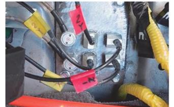
写真-6 乗用車に設置した加速度計の例
