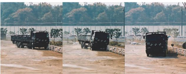
写真-4 防護柵の衝突試験状況の一例
