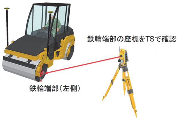
図-2 鉄輪端部検測イメージ
