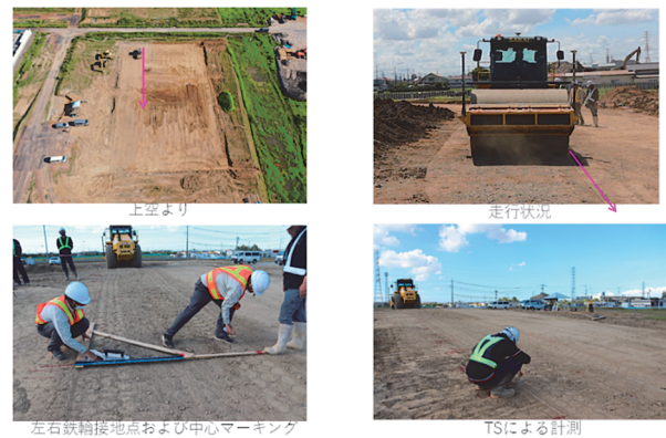
写真-2 走行状態での精度確認実施状況
