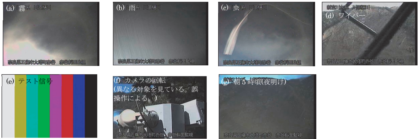
写真-3 誤検知が発生しやすい現象の例
