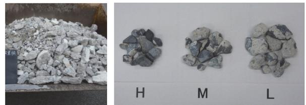
図-3 コンクリート塊(左)と再生骨材(右)
