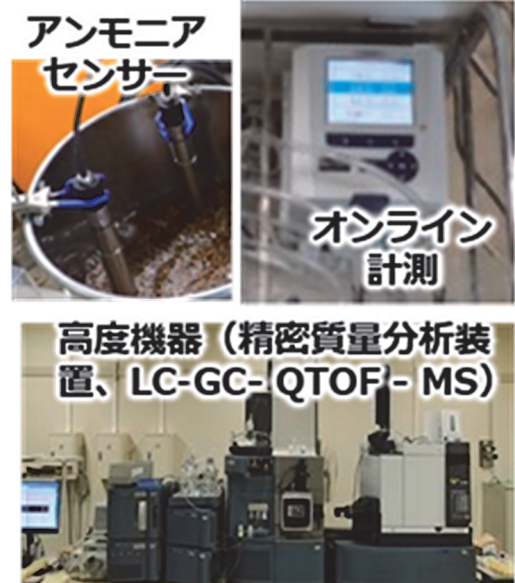
写真-4 下水水質監視システムの開発
