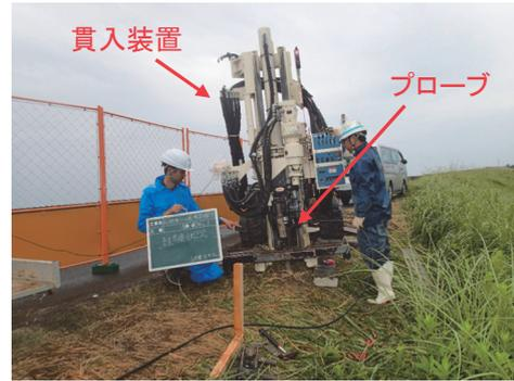
写真-2 液状化予測の評価のための地盤調査技術の改良
