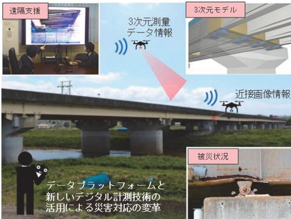
写真-3 デジタル技術の活用による地震後の橋の状態把握手法の変革イメージ
