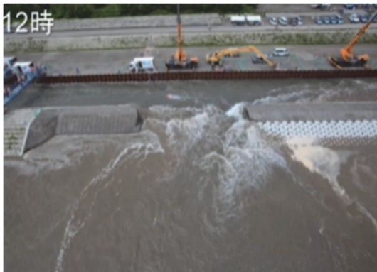
写真-2 実物大河川模型による検証実験
