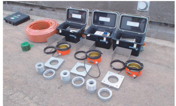
(a) 緊張力計測システム機器
