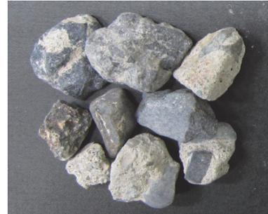
写真-1 再生骨材の例
