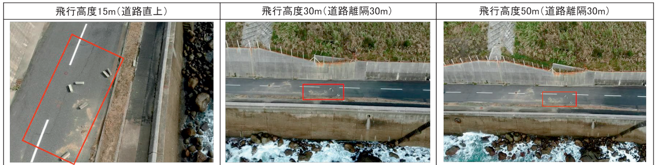
図-5 被災状況確認結果の一例 (③20cmブロック、使用機体：Matrice300RTK、解像度：1920×1080)
