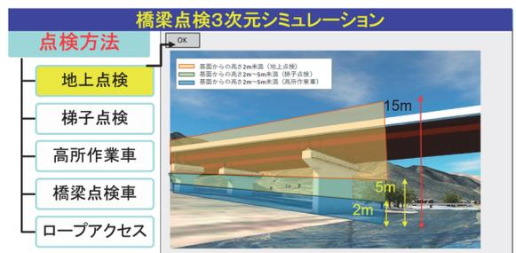
図-3 点検方法（地上点検）の点検可能範囲のイメージ
