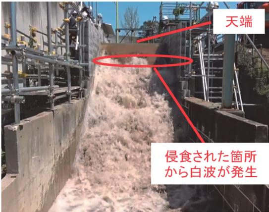
図-2 過去実験における通水中の裏のり面の状況
