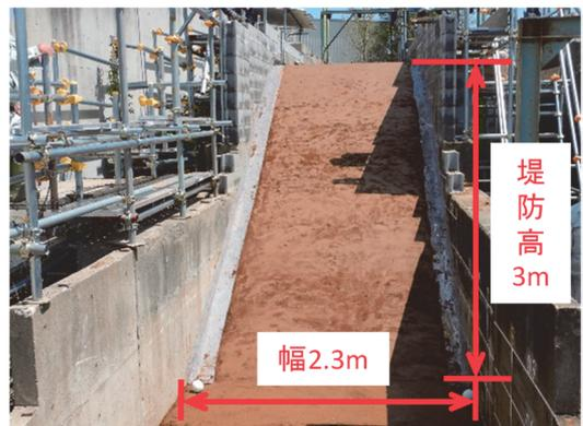
図-1 過去実験における通水前の裏のり面の状況
