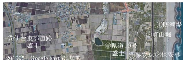
写真-29 平野部の海岸の広域多重防御：仙台市荒浜で保護され、特に、山側の法尻はコンクリート（Co）版、側溝により侵食防止が施されている。
