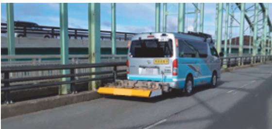
写真-2 車載式電磁波レーダ
