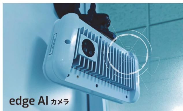
写真-6 エッジAIカメラ 雨天や高温、衝撃に耐えるため、強固な外殻と排熱板を有す
