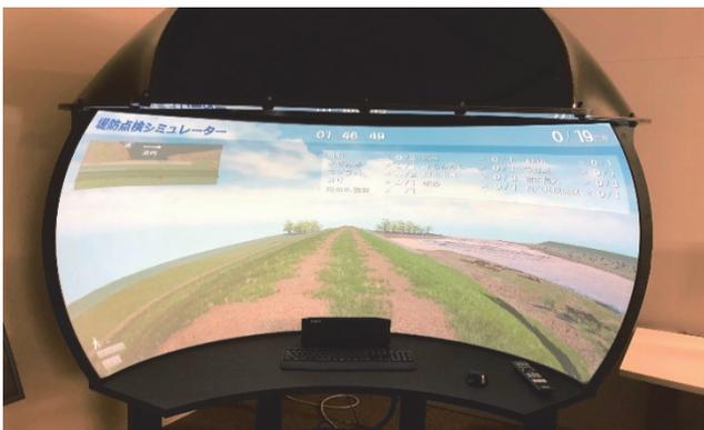
写真-9 ドーム型モニターによるVR研修表示例
