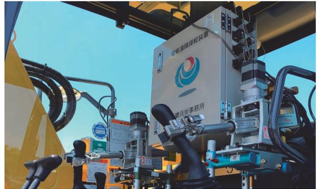
写真-5 遠隔操作実習機
