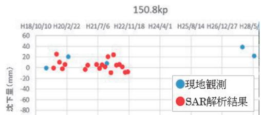
図-6 盛土沈下箇所の現地観測とALOS-2SAR解析結果<sup>3)</sup>に追記
