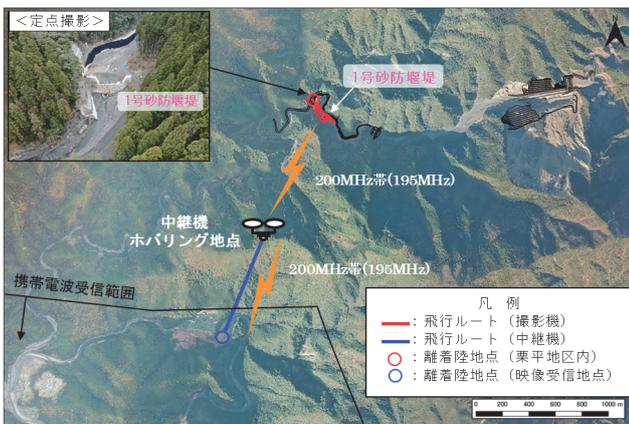
図-11 公共BBを搭載したUAVの飛行ルート
