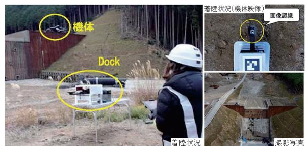
図-10 離発着を含む完全自律飛行の検証
