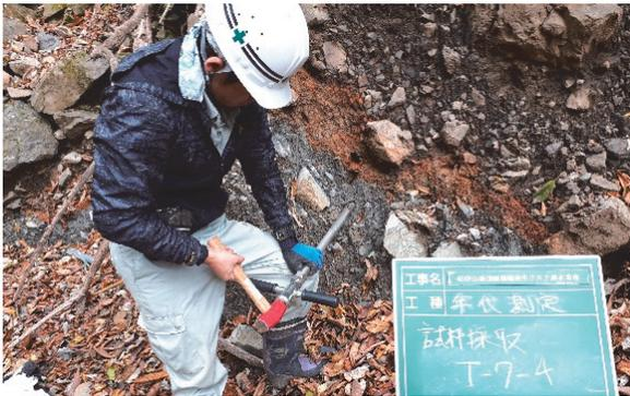
写真-2 サンプラーを使用した炭化物採取状況
