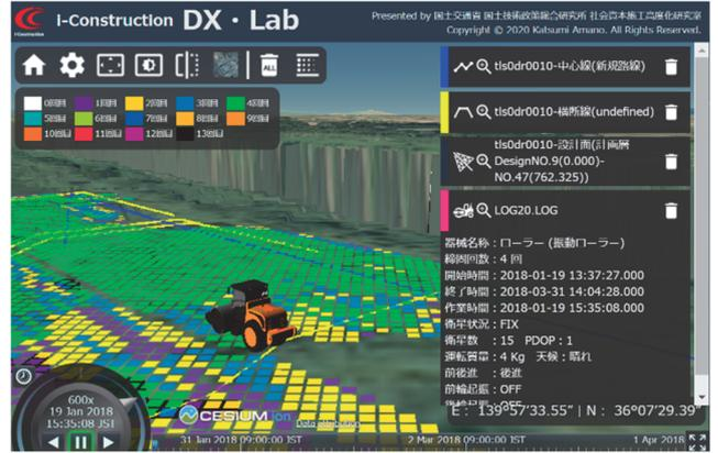
図-10 建機の施工履歴データの表示
