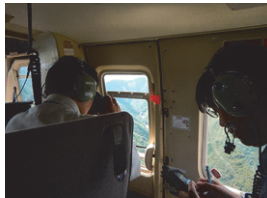
図-8 「高度な土砂災害対策に従事する地方整備局職員の育成支援プログラム」の実施状況（ヘリの機内からレーザ距離計で河道閉塞〔天然ダム〕の高さを計測する様子）
