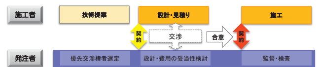
図-3 設計交渉・施工タイプのフロー
