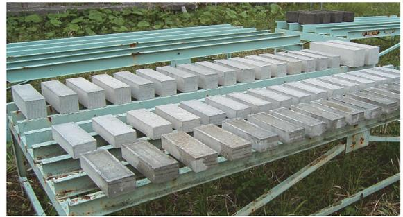
写真-1 暴露試験の状況（北海道千歳市）
