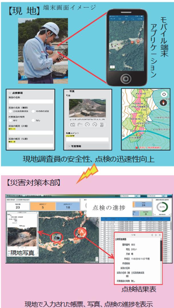
図-2 モバイル端末(現地)とPC端末(災害対策本部)による運用イメージ
