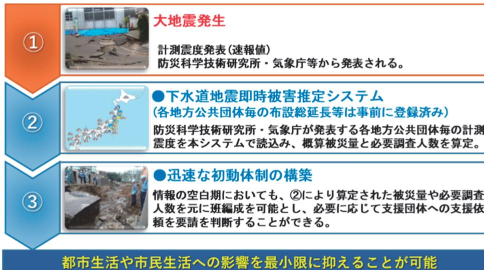
図-1 下水道地震被害即時推定システム活用フロー
