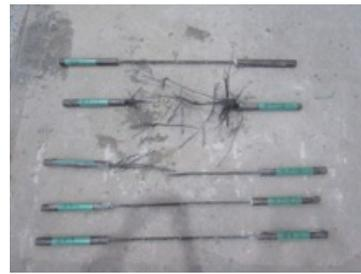
図-2 アルカリ浸漬した供試体の引張試験後の様子
