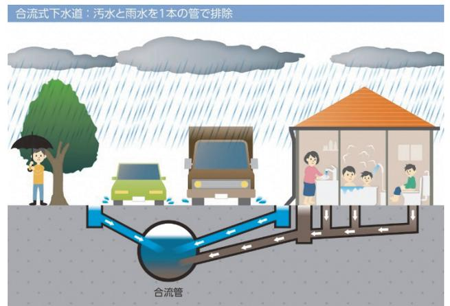
図-1 合流式下水道の仕組み
