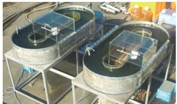
図-2 上部開放レースウェイ型藻類培養装置(380L)
