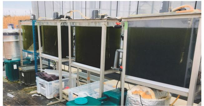
図-5 密閉縦型藻類培養装置(50L×4連)
