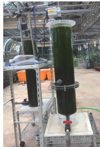
図-9 上部開放カラム型藻類培養装置(30L)
