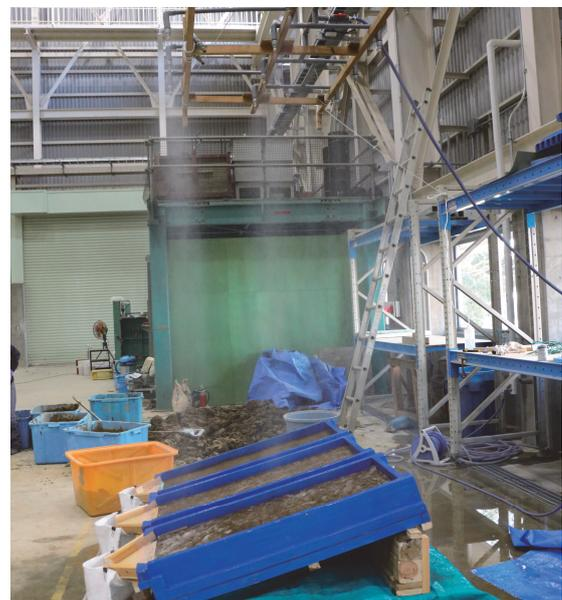
図-10 土槽供試体設置状況と降雨装置
