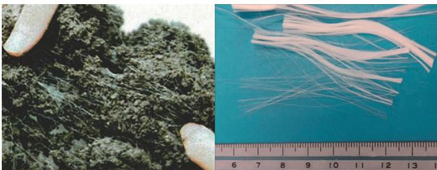
写真-1 短繊維混合補強土
