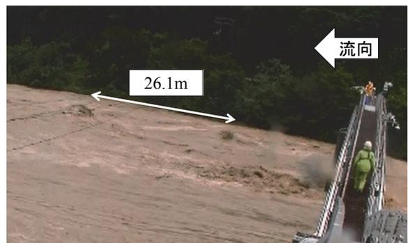
図-10 洪水時の流況と水面波の波長
