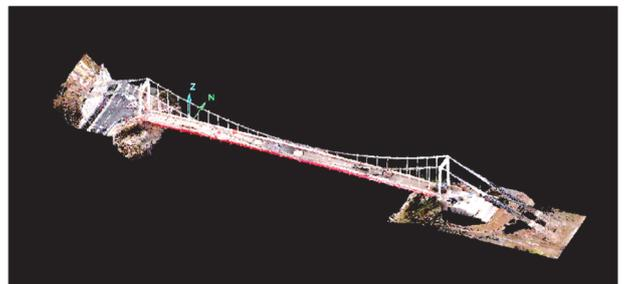
図-2 吊り橋の3Dモデル
