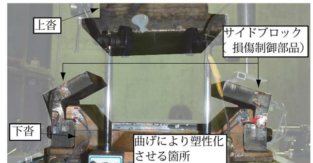
写真-3 実験後の損傷制御型支承の状況(支承1)
