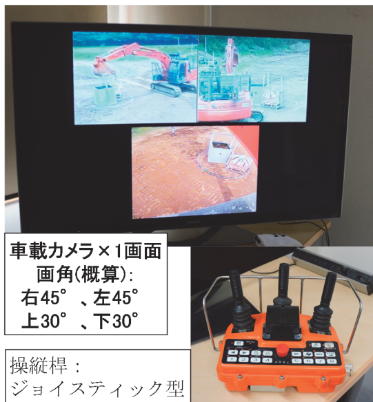
図-11 一般的な無人化施工の操作環境
