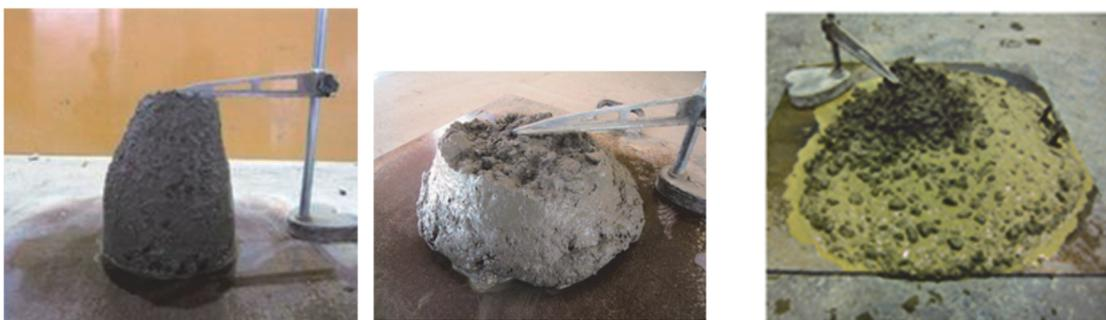
図-5 スランプの比較 (左：スランプ7cm，中：スランプ19cm，右：スランプ18.5cm)
