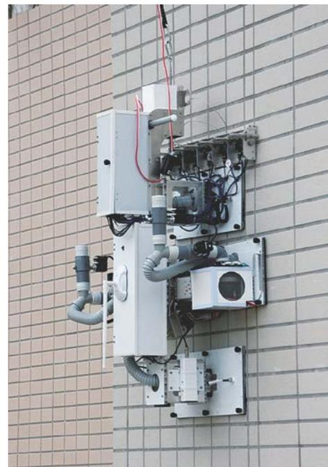
写真-1 壁面走行型外壁診断装置（プロトタイプ）
