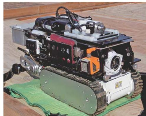
写真-3 木造建築物の予防保全的管理のための床下劣化診断装置（遠隔操作回転機能付き）
