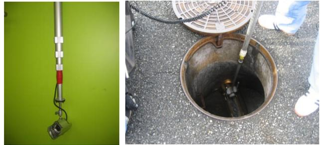
写真-2 管口カメラ（写真左）および使用状況
