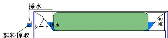
図-4 採水および袋高さ確認状況
