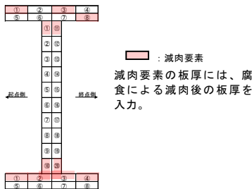
図-10 下弦横桁の腐食減肉を考慮したファイバー要素モデル
