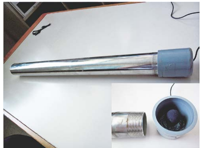
写真-1 ハイドロフォンの写真
